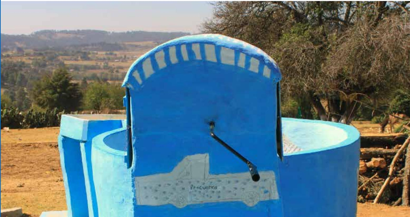
Fotografía: Bomba de mecate y pileta de lavado. Sistema de captación de agua pluvial
